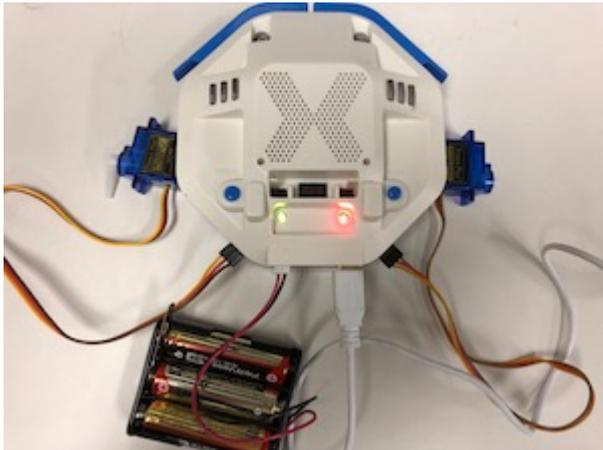
次のプログラムでは、左右のサーボモータの角度を180度から0度に変更するプログラムである。サーボモータの動作には時間がかかる。このため、動作の完了までの待ち時間を作るために「プロッチ!1 待つ。」の命令で角度を180度に設定した後、1秒間の待ち時間を設けている。
